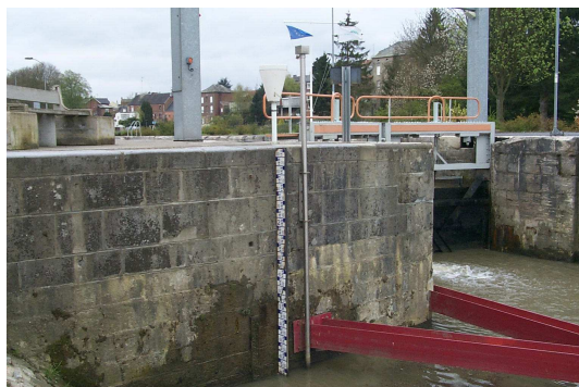
Echelle et limnimètre à Berlaimont (Artois-Picardie)
