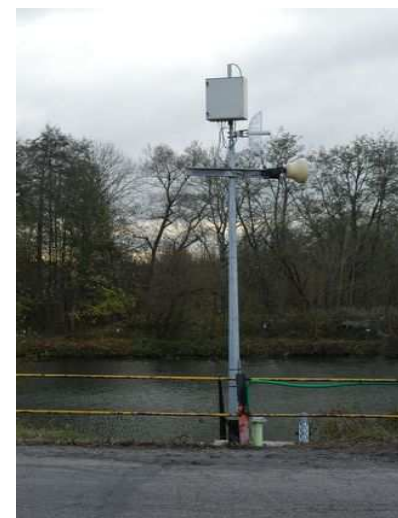
Station de mesure par caméra vidéo à Damelevières (Moselle)
