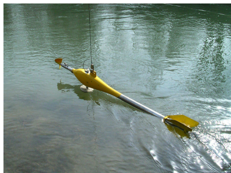
Jaugeage au moulinet
